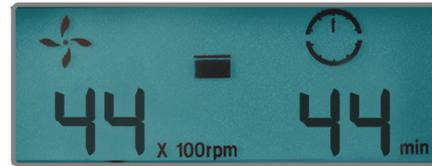
Drücken Sie SELECT. Wenn das Programm blinkt, können die Einstellungen geändert werden. Drehen Sie den Einstellregler (fig 1.) im Uhrzeigersinn, um die Wert zu erhöhen oder gegen den Uhrzeigersinn, um die Werte zu verringern.
