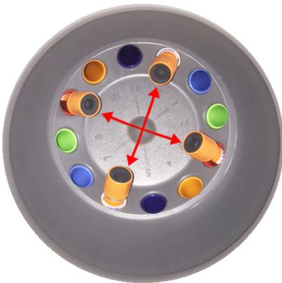
Orientieren Sie sich an den Farben, um die Entnahmeröhrrchen richtig zu platzieren
