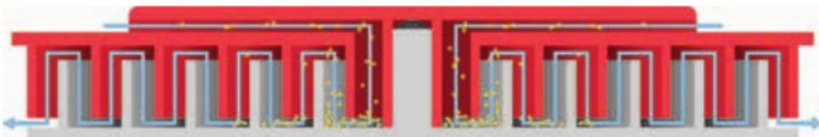
Das Ringrippen-Labyrinth stoppt die Mikroben, Keime und Partikel im Belüftungsstrom. Somit bleibt das Sterilgut im Container dauerhaft geschützt.
